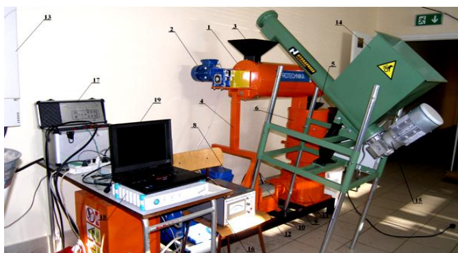
Rys. 1. Stanowisko badawcze z nowym prototypowym urządzeniem granulująco-brykietującym z płaską nieruchomą matrycą Fig. 1. Test stand with a new granulating-briquetting prototype device with a flat fixed matrix
