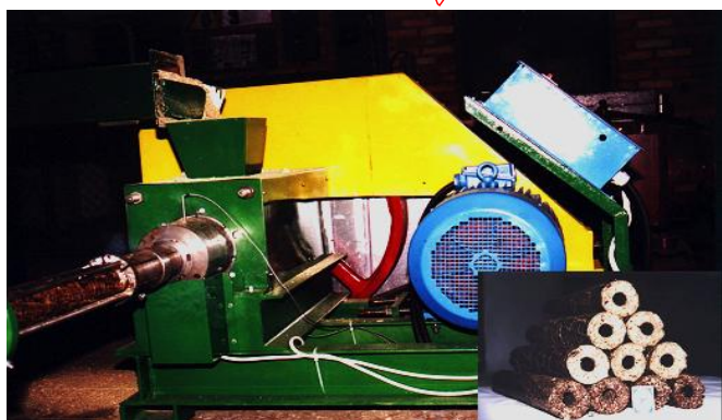
Rys. 2. Stanowisko do badania procesu brykietowania Fig. 2. Test position for briquetting process research
