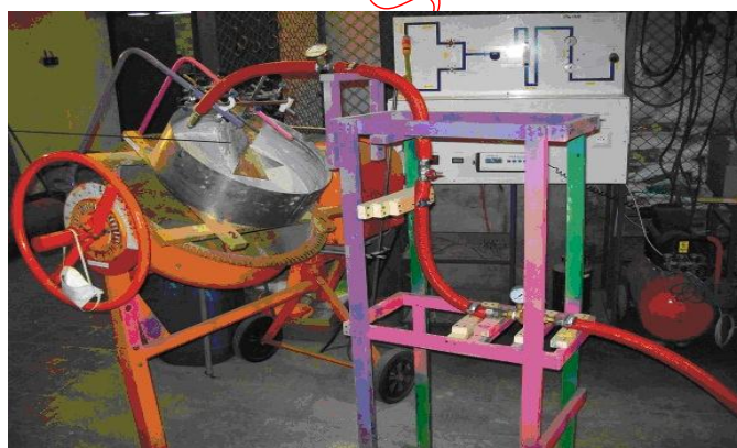
Rys. 3. Stanowisko badawcze do bezciśnieniowej aglomeracji Fig. 3. Test stand for non-pressurized agglomeration
